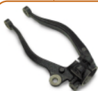
ダンパーフォーク 従来の鍛造から、生型での一体化成形を可能にしました。 生型 / FCD550
